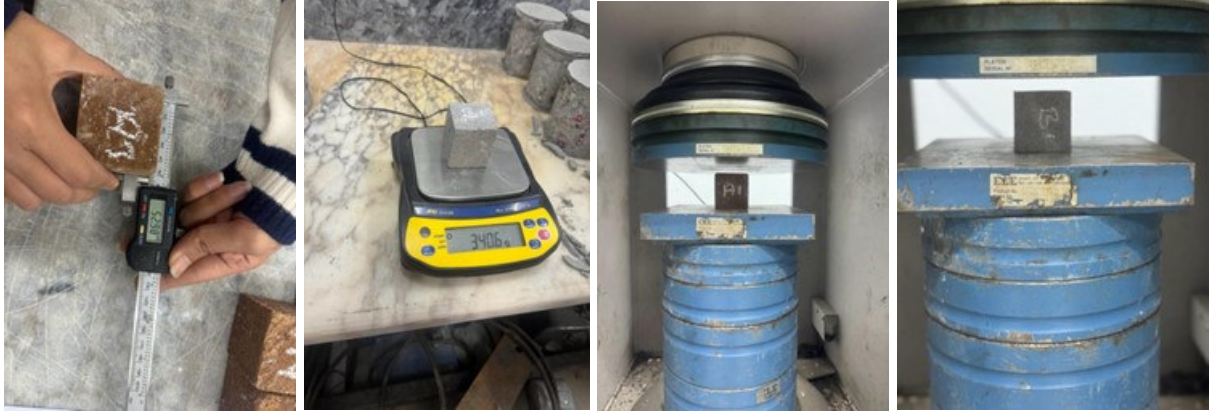
Şekil 8. Numunelerin boyut ve ağırlıklarının ölçülmesi ve tek eksenli basınç deneyi düzeneğine yerleştirilmesi
