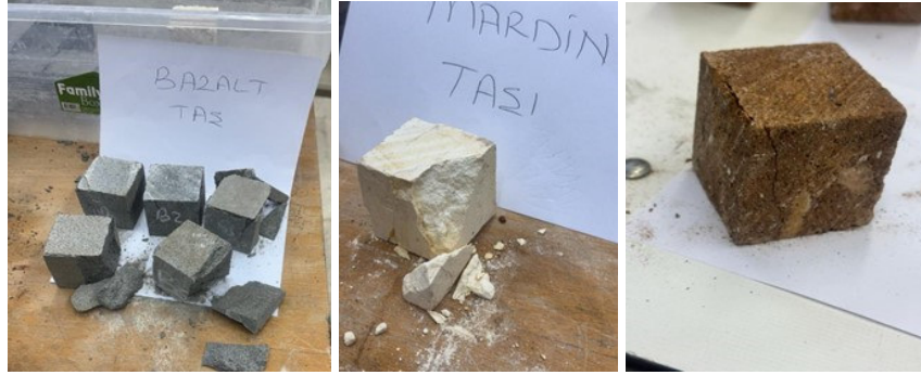
Şekil 9. Tek eksenli yük altında basınç deneyi sonrası kırılan taş numuneleri
