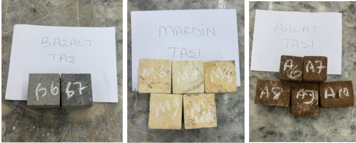
Şekil 11. Tek eksenli yük altında basınç deneyinde kullanılan numuneler
