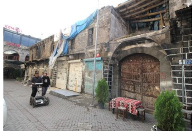
Şekil 12. Çifte Han çevresinde ve avlusunda GPR ölçüm hatları
