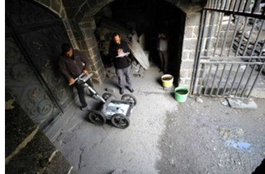
Şekil 11. Çifte Han Georadar (GPR) taramalarında kullanılan cihaz
