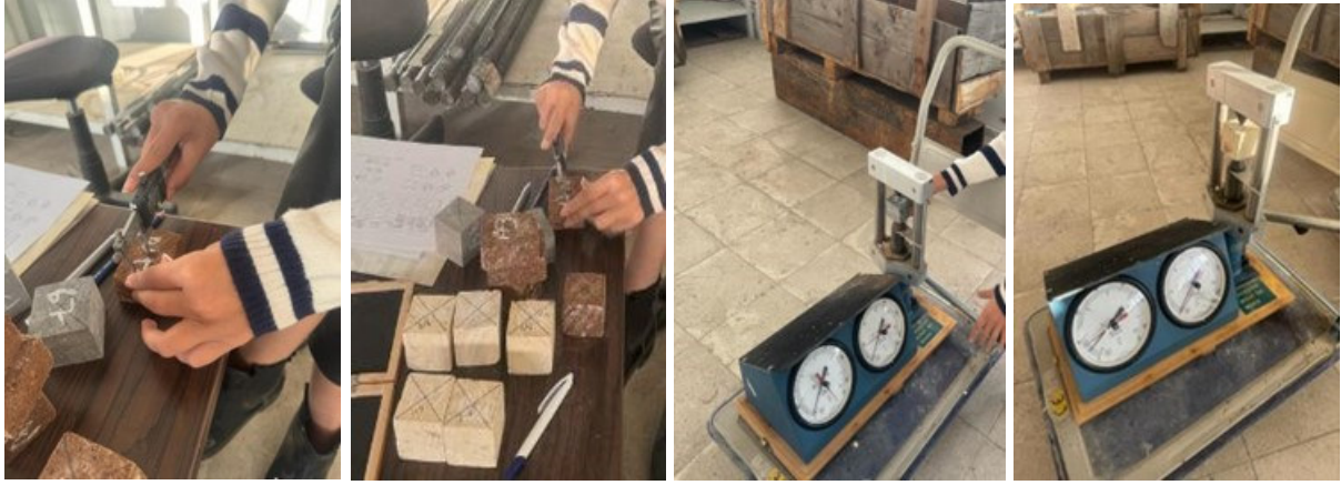
Şekil 12. Numuneler üzerinde orta noktanın belirlenmesi ve deney aşaması
