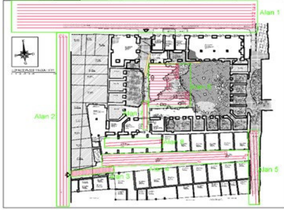
Şekil 12. Çifte Han çevresinde ve avlusunda GPR ölçüm hatları
