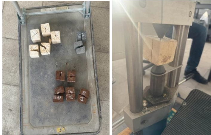
Şekil 13. Nokta yük dayanım deney sonrası numunelerin durumları
